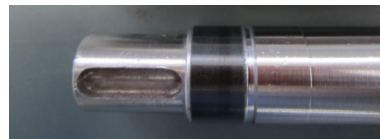
セラミックコーティング品 → 摩耗なし
