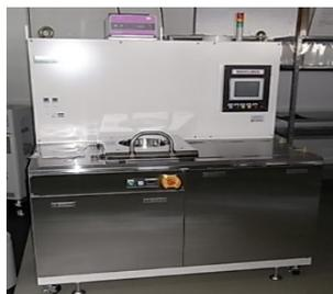
半導体製造装置などクリーンな環境で、清浄度の求められる部品の洗浄(クリーン洗浄・精密洗浄)を行っております。
