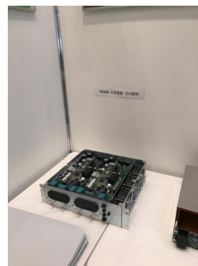
SiC 採用 DC/DC コンバータ
